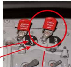
2. Der Sicherungsstift befindet sich auf der rechten Konsole in der hinteren Aufnahmebohrung (Version GS rechts vorne, bei der Version GT rechts). Den Sicherungsstift für den Schleudersitz seitlich von rechts in den Abzugsgriff »FIRING HANDLE« stecken!
