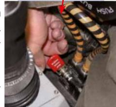
In der GS-Version (Einsitzer) wird die Kabinenabwurfanlage links hinter dem Sitz mit dem Sicherungsstift gesichert.
