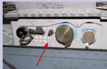
Schalter »CANOPY« in Stellung »OPEN« umlegen und das Dach öffnet sich.
