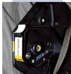
1. Sicherungshebel »SAFE / ARMED HANDLE« von »ARMED« in »SAFE« Position drehen!
